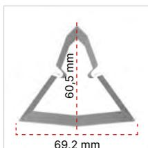
Pied en profilé de tôle d'acier ép. 2 mm, à section 60,5x69,2 mm.
