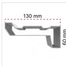
Cadre tout autour en profilé de tôle d'acier ép. 1,5 mm, à section 130x60 mm.
